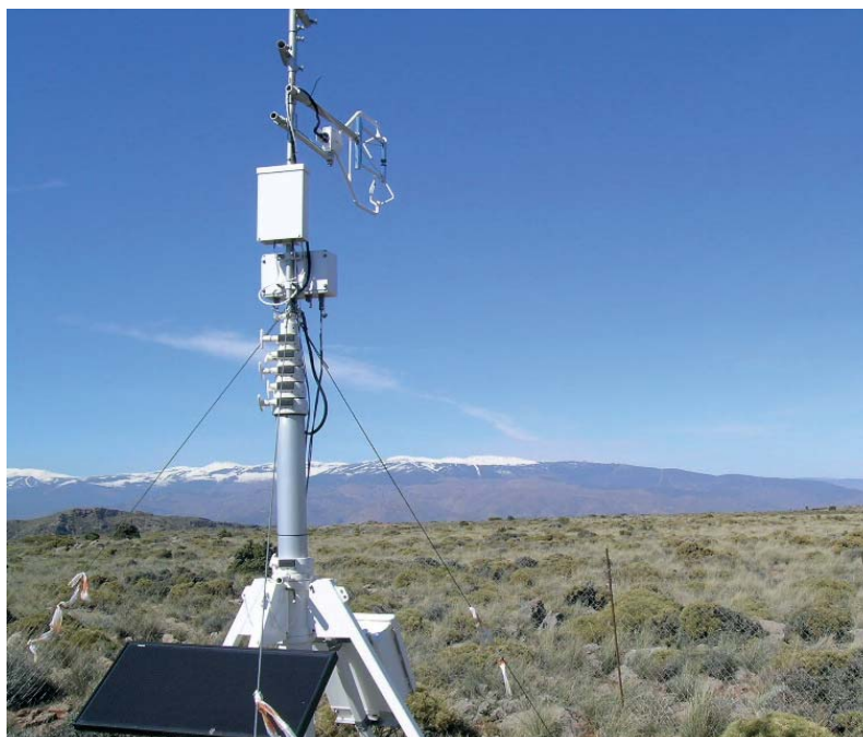
Torres de correlación de remolinos ( Eddy Covariance ). Miden el intercambio neto de CO 2 entre la atmósfera y la superficie terrestre.
