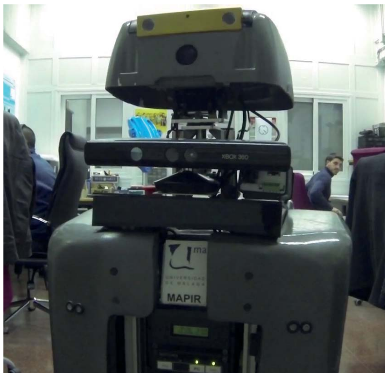
Robot SANCHO del grupo de percepción artificial y robótica inteligente de la Universidad de Málaga, usado en los experimentos de teleoperación del proyecto
