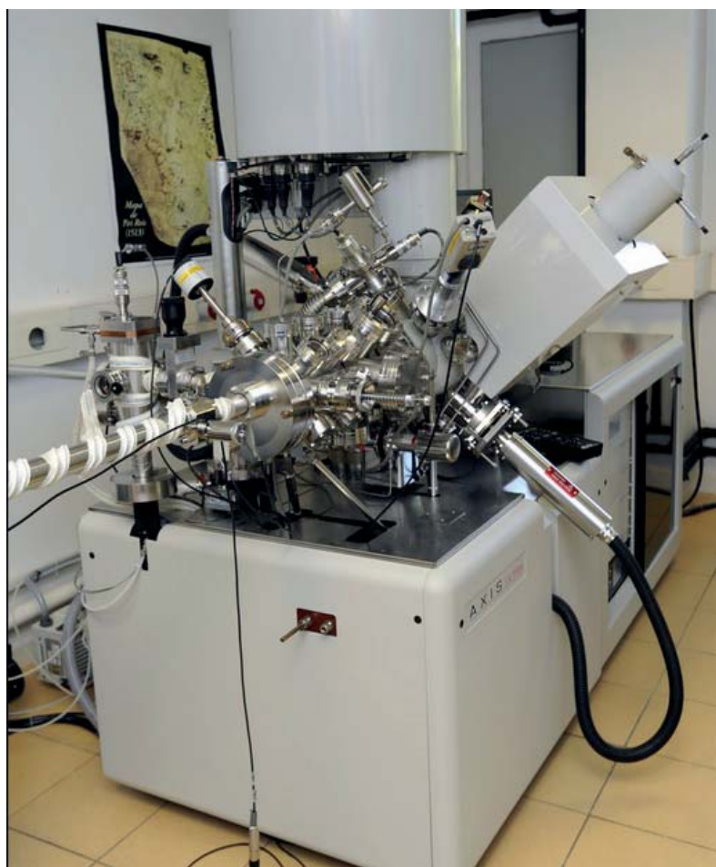
Espectrómetro de fotoelectrones de Rayos-X Kratos Axis Ultra-DLD del Centro de Instrumentación Científica de la Universidad de Granada
