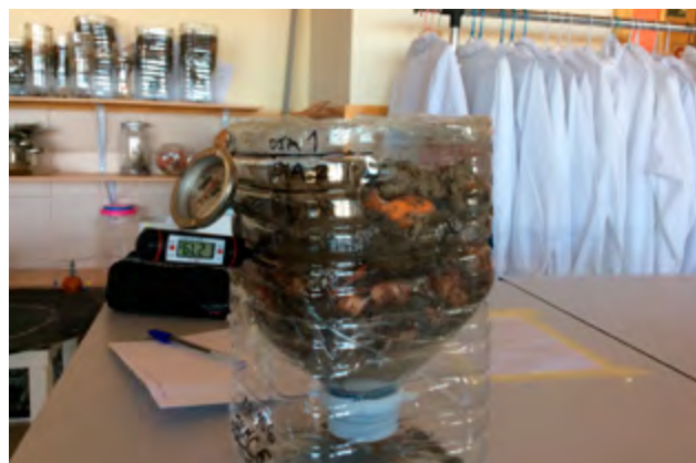
Toma de la temperatura de diferentes zonas de las composteras en botellas de plástico.
